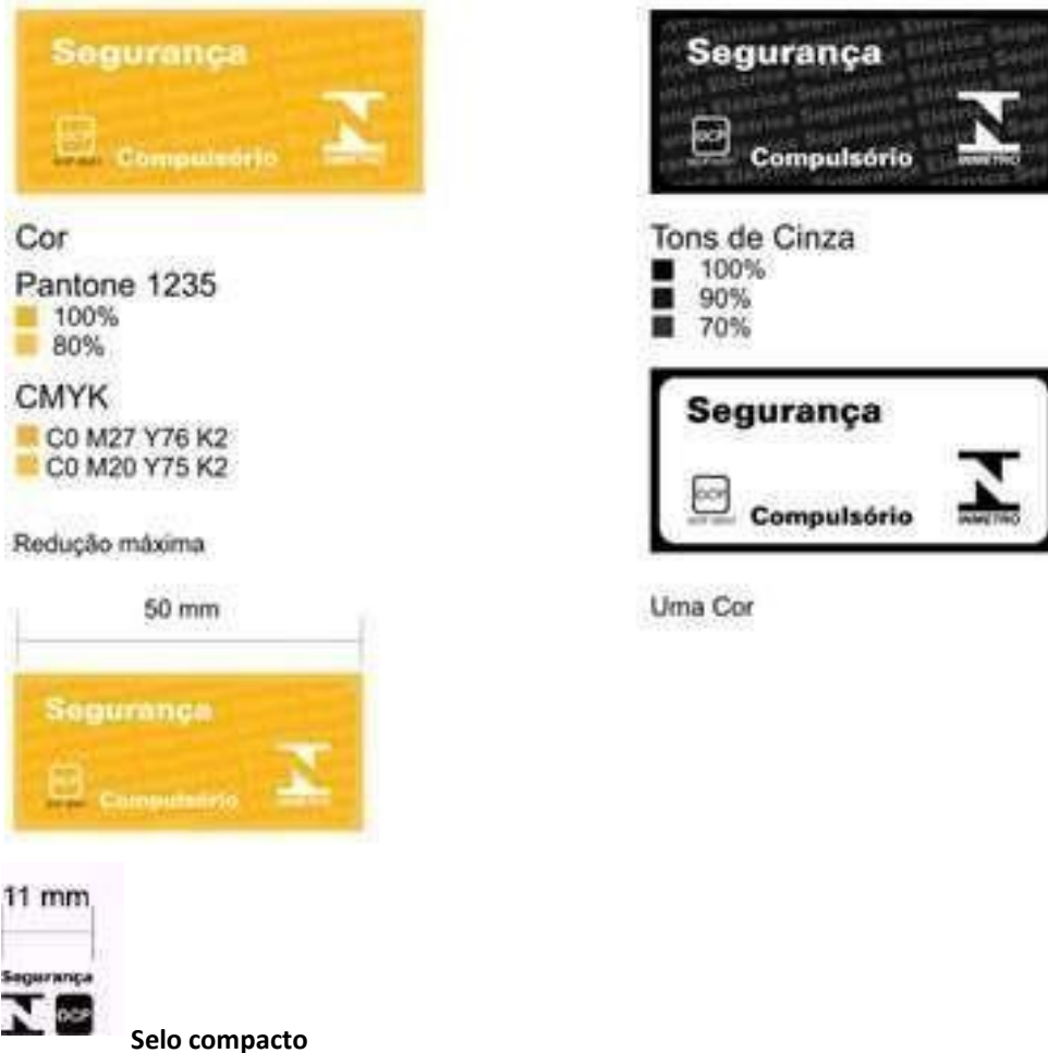
Figura 2 - Selo de Identificação da Conformidade para plugues e tomadas certificados até a data de vigência desta Portaria
